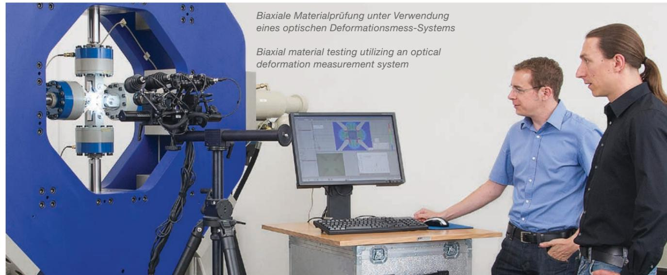
*Biaxiale Materialprüfung unter Verwendung eines optischen Deformationsmess-Systems*
