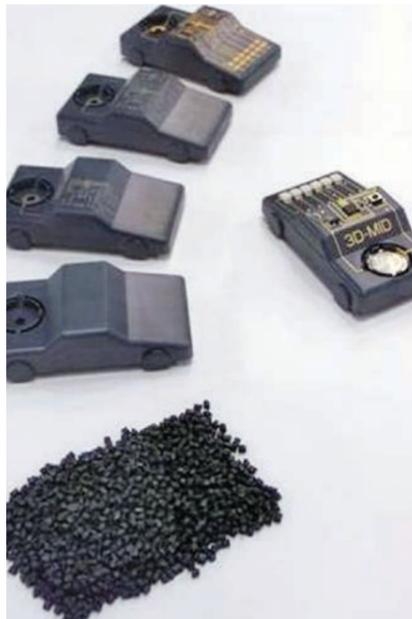
3-D MID Demonstrator – Fertigungsstufen
