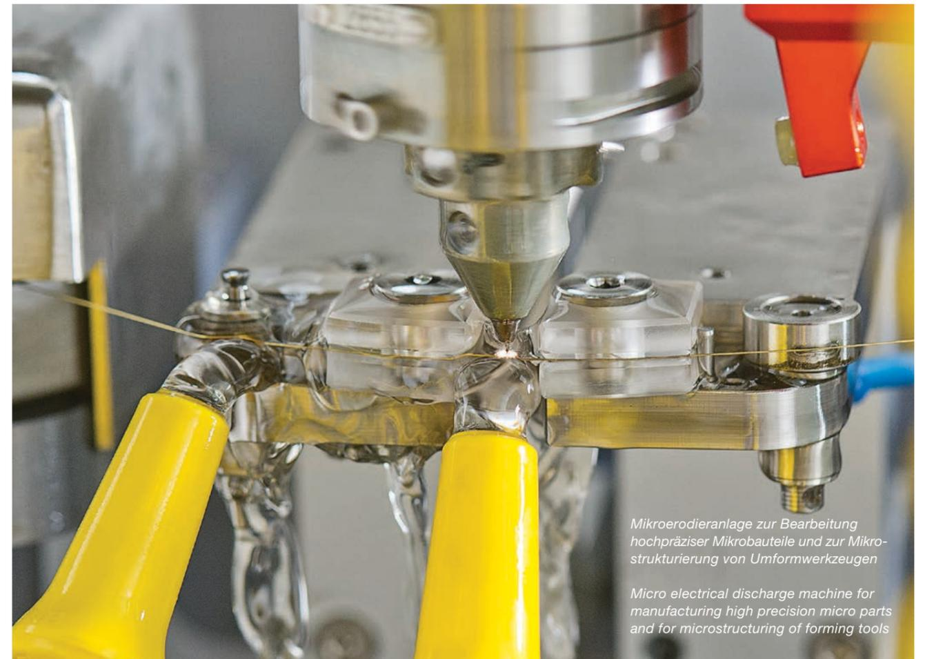
*Mikroerodieranlage zur Bearbeitung hochpräziser Mikrobauerteile und zur Mikrostrukturierung von Umformwerkzeugen*
